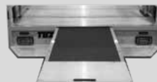
Hecktür mit ausziehbarer Laderampe
